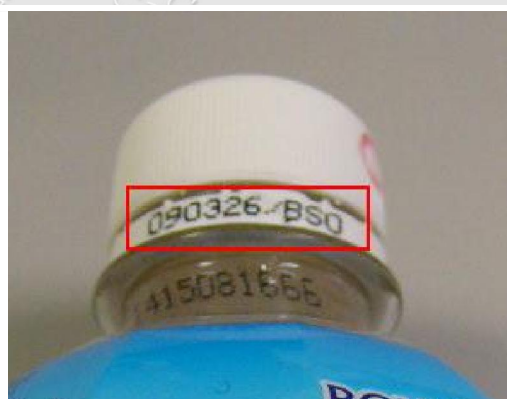
饮料瓶体上的生产日期和生产批号打印质量检查
